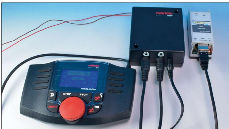
Das CAN-Bus-Interface von JSS-Elektronik wird einfach am freien CAN-Bus-Anschluss der Gleisbox von Märklin angesteckt. Die Stromversorgung des Interface erfolgt direkt aus dem CAN-Bus. Sofern das Interface innerhalb der ersten 60 Sekunden nach Systemstart kein bekanntes WLAN findet, startet es ein eigenes WLAN, mit dem man sich zur Konfiguration verbinden kann.
